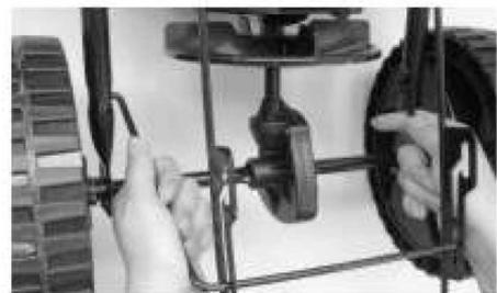
**9. Verbinden Sie die den Bowdenzug der Streumengenregulierung mit der Streueinheit.**
