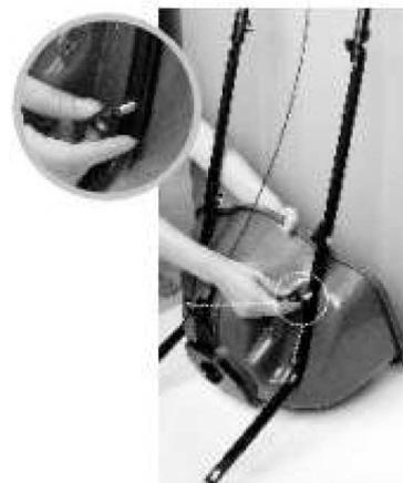
3. Montieren Sie das Streurad an den Streumitteltank (wie in der Abbildung zu sehen)
