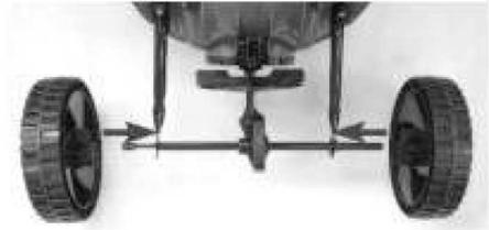
**7. Fixieren Sie die Räder mit den Splinten auf der Radachse.**
