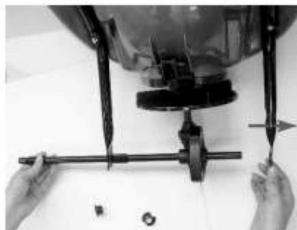
5. Führen Sie die Radachse durch die Winkelrohre und fixieren Sie diese mit den Achsbuchsen.
