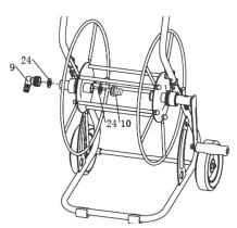
6 Montieren Sie die ½" (13 mm) Vaterteil-Kupplung (9) mit dem dazwischen angebrachten Gummidichtring (24) am Flanschende und ziehen Sie diese von Hand oder mit Werkzeug fest.
