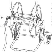
**7** Befestigen Sie den Zuleitungsschlauch über die  $\frac{1}{2}$ " (13 mm) Schnellkupplung aus Kupfer (11) und schließen Sie ihn an die  $\frac{1}{2}$ " (13 mm) Vaterteil-Kupplung (9) an der Haspel an. Schließen Sie das andere Ende an die Wasserleitung an (Kupplung nicht im Lieferumfang enthalten).
