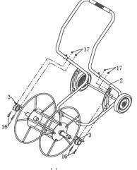
**4** Setzen Sie die beiden Lager (3) an den Enden der Flansche (4 und 5) ein. Richten Sie die Öffnungen der Lager (3) auf die Öffnungen im Rahmen (2) aus. Befestigen Sie beide Seiten der Lager mit Schraube M6x30 (16) und M6-Nylonmutter (17). Verwenden Sie dazu einen Schraubenschlüssel und den mitgelieferten Innensechskantschlüssel.
