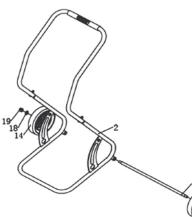
2 Setzen Sie die Achse (13) in die Achsöffnungen an beiden Seiten des Rahmens (2) ein. Schieben Sie die Vollgummiräder (14) über die Achse und achten Sie dabei darauf, dass die Radkappen nach außen weisen. Befestigen Sie die Räder mit Unterlegscheiben Ø10 (18) und M10-Nylonmuttern (19) mit einem Schraubenschlüssel an der Achse.
