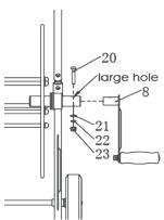
**5** Setzen Sie die Handkurbel (8) in die Nabe am Ende des Flanschs (5) ein. Richten Sie die Öffnungen in der Handkurbel aufeinander aus und befestigen Sie die Handkurbel mit Schraube M8x40 (20), M8-Unterlegscheibe (21), M8-Federring (22) und M8-Nylonmutter (23). Verwenden Sie dazu einen Schraubenschlüssel und den mitgelieferten Innensechskantschlüssel.
