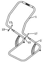
1 Stecken Sie den u-förmigen Griff (1) auf den Rahmen (2). Platzieren Sie eine Schraube M6x25 (15) in eines der Löcher im Rahmen und befestigen Sie diese mit einer M6-Nylonmutter (17). Verwenden Sie dazu einen Schraubenschlüssel und den mitgelieferten Innensechskantschlüssel. Führen Sie diese Arbeitsschritte auch auf der anderen Seite durch.
