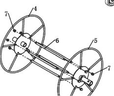
**3** Setzen Sie die beiden Enden der Verbindungsstäbe (6) in die dafür vorgesehenen Öffnungen im rechten Flansch (4) und im linken Flansch (5) ein. Befestigen Sie diese mit einer M8-Hutmutter (7).
