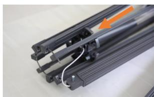
Fädel den Seilzug wieder zurück und befestige diesen am unteren Strebenkranz (B). Den oberen Strebenkranz mit den Schrauben montieren, so wie du sie auch gelöst hast.
