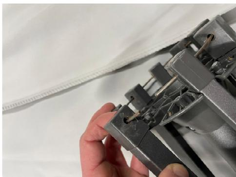
6 Löse das defekte Strebenstet aus der Draht-Halterung am oberen und unteren Strebenkranz (A/B). Halte das neue Strebenstet bereit.
