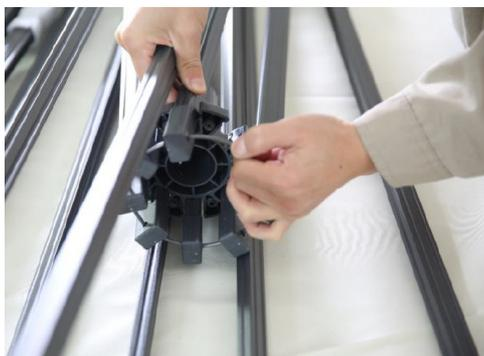
7 Setze das neue Strebenpaar am oberen und unteren Strebenkranz passend ein (A/B).
